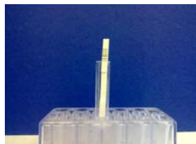
INSERIRE IL DIPSTICK NELLA PROVETTA
